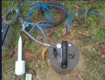
Short-period Seismometer iCRG SFI RESEARCH CENTRE IN APPLIED GEOSCIENCES Geological Survey Suirbhéireacht Gheolaíochta Ireland | Éireann An tAonú Ceanglaíocht, Aeráil agus Comaíocht Department of the Environment, Climate and Communications
